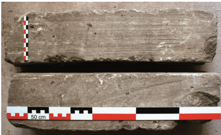
Fig. 32a : Sciage à la sciote et brisure centrale
