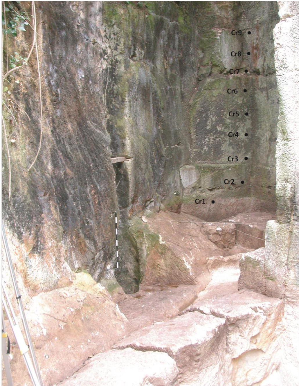
Fig. 2 : La carrière de Crazannes, à Champ Loiseau : à gauche, le puits antique tranché verticalement par l'exploitation de la carrière, à droite, la série des 9 prélèvements effectués tous les 50 cm sur le front de taille afin de réaliser le référentiel de la pierre de Crazannes (fouilles et cl. J. Gaillard)
